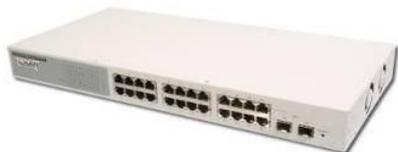
Switch con 16 o 24 porte Gigabit e 2 moduli per l'uso di cavi in fibra ottica. Compatibile IEEE802.3, IEEE802.3u, IEEE802.3x.. Funzione Auto MDI/MDI-X. MAC Address 8 K e 400 Kb su chip frame buffer. Supporto QOS, classificazione Layer 4. Mirroring delle porte. Con prestazioni e sicurezza VLAN. Con due porte Dual Media (SFP) per connessioni flessibili. Gestione basata sul Web.
