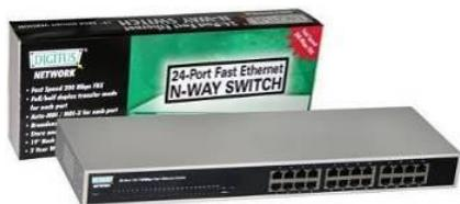
Compatibile IEEE802.3 e IEEE802.3u. - Con 24 porte RJ45, auto MDI I, 2 MB buffer, 1K FAT address filter matrix. 20/200 Mbit full duplex, Half/full duplex per tutte le porte. Backpressure flow control in modalita' half duplex Trova automaticamente le velocita' e la configurazione, architettura store and forward, 3 led per mostrare lo stato operativo, conforme FCC e CE Predisposto per il montaggio in armadi Rack 19"
