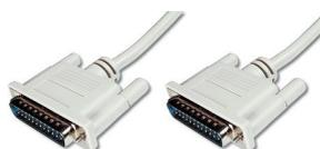
CAVO BIDIREZIONALE PER STAMPANTE PARALLELA standard IEEE 1284 - UL20276 - doppia schermatura Cavo schermato con coppie intrecciate TWISTED PAIR Connettori: 25 poli Maschio/36 poli Maschio
