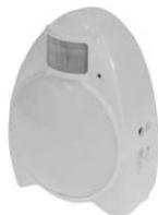
Area di copertura 90°, 6m di profondità. Il movimento attiva automaticamente la luce, che si spegne dopo 15 sec. circa. Grazie ad un sensore interno si attiva solo in assenza di luce. Senza fili, può essere facilmente spostato da una stanza all'altra. Funziona con 4 batterie "AA" o con alimentatore DC 6V, 600 mA (non incluso). Lampadina: KR 4.8V 0.5A; inclusa una lampadina di ricambio.
