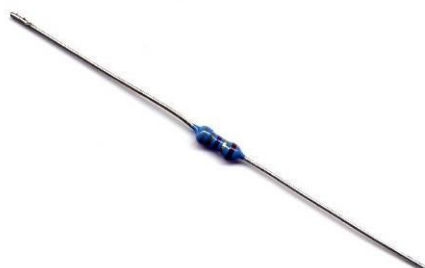
resistenze a strato metallico 1/2W tolleranza 1%
