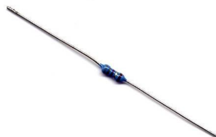
resistenze a strato metallico 1/2W tolleranza 2%
