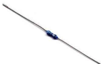
resistenze a strato metallico 1/4W tolleranza 1%
