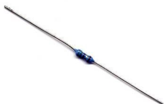
resistenze a strato metallico 1/4W tolleranza 2%
