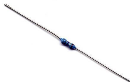
resistenze a strato metallico 1/2W tolleranza 1%
